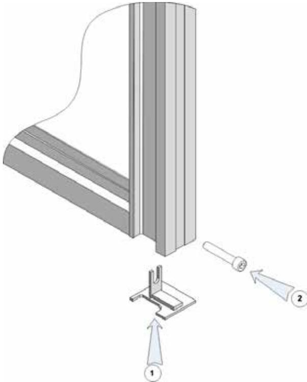
Вторая половина двери собирается аналогично. Исключение составляет только фурнитура. Во вторую половину необходимо установить крепление верхнего ролика, комплект петель, а так же штырь от стопора распашного механизма.
