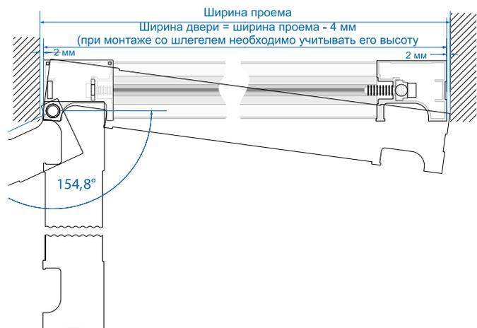
Расчет высоты двери и длины вертикального профиля:  $H(\text{двери}) = H(\text{проёма}) - 20 \text{ мм}$ .
