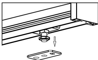
5 Выставьте дверь в проем. Отрегулируйте с помощью специального ключа по высоте. Разметьте и зафиксируйте нижние ответные планки.
