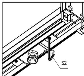
2 Разметьте и просверлите отверстия в направляющей. Зафиксируйте направляющую к стене.
