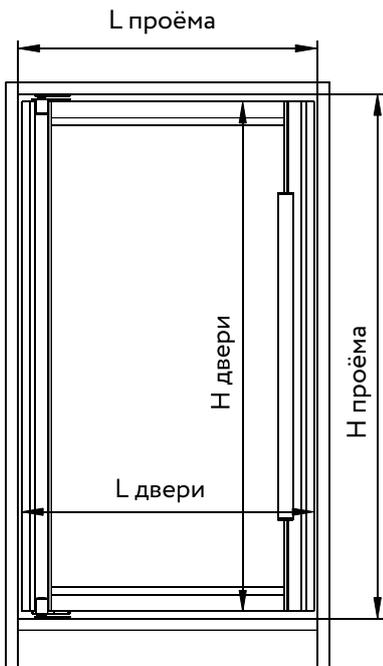
$$L \text{ двери} = L \text{ проёма} - 10 \text{ мм}$$
