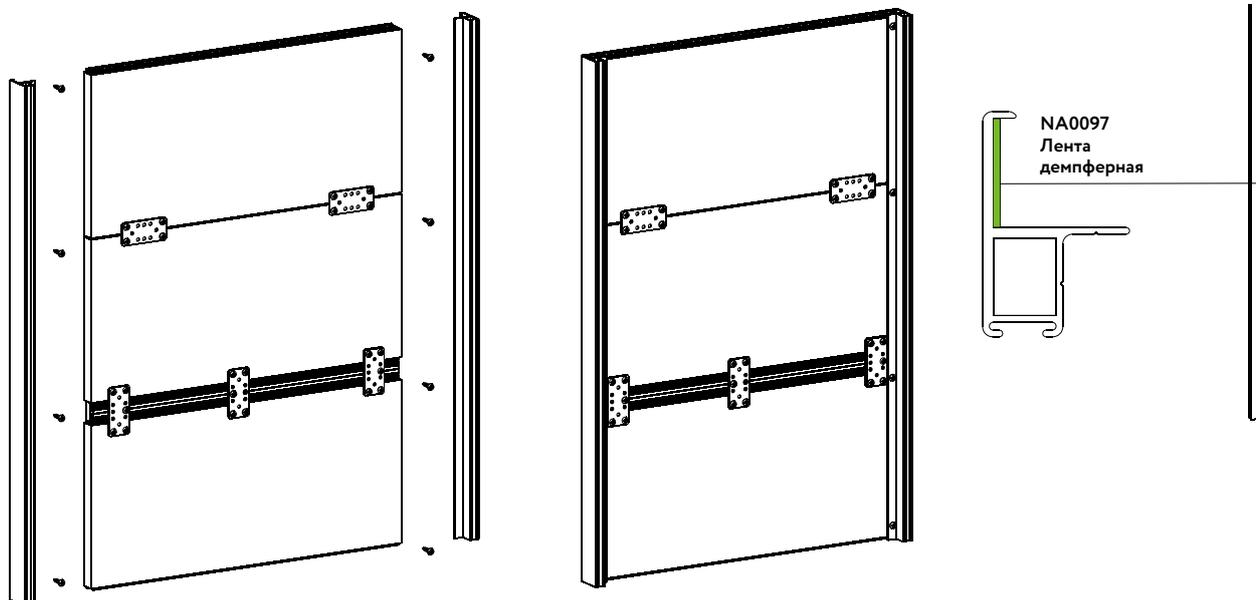
10 Зафиксируйте усилитель вертикальный (NB0638) саморезами 3,9х16 мм, используя предварительно просверленные отверстия Ø 4 мм с шагом 300-400 мм. Если вставка с зеркалом/стеклом, то используйте саморез 3,9х9,5 мм.
