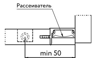
Система GOLA. Установка профиля для верхней базы, под подсветку, для плиты 18 мм
