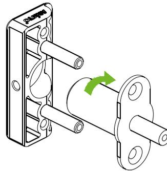
**3** Установите замок в профиль А и зафиксируйте винтами.
