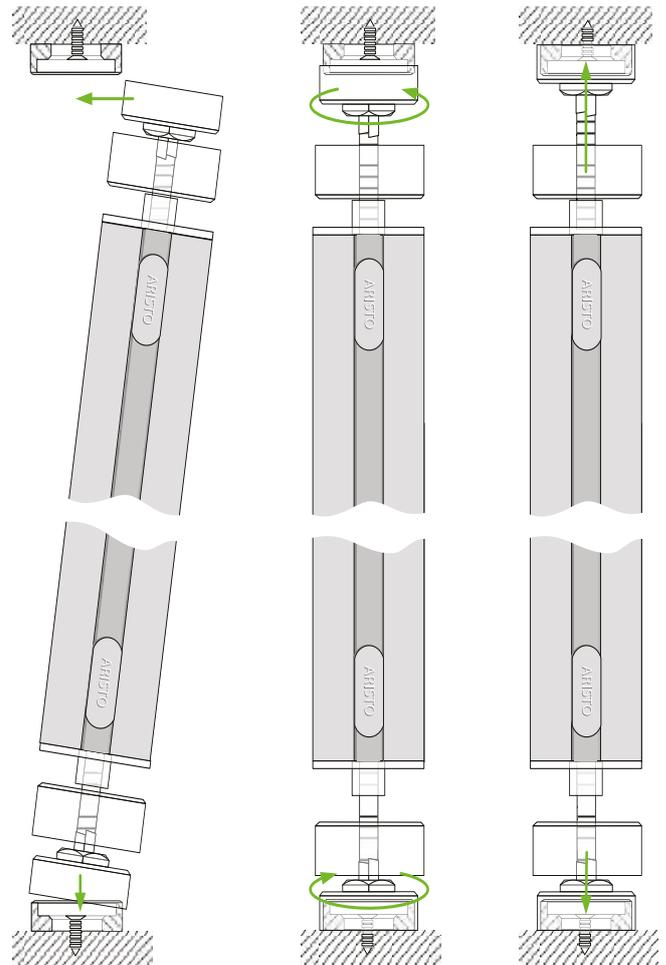
**11** С помощью регулируемых винтов зафиксируйте перегородку на вкладышах-фиксаторах. Одновременно откорректируйте высоту и горизонт.
