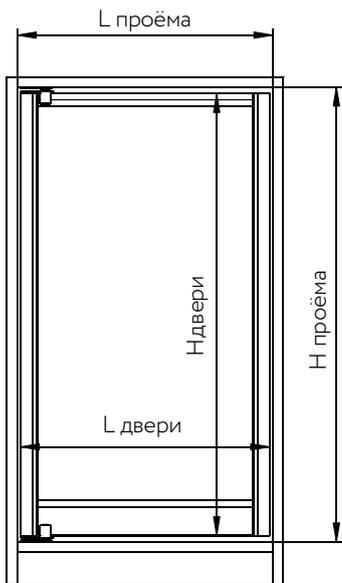
$$L \text{ двери} = L \text{ прёма} - 10 \text{ мм}$$
