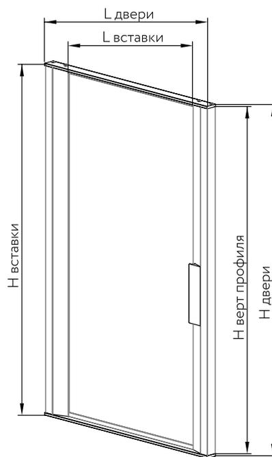
$H_{\text{верт. профиля}} = H_{\text{двери}} - 10 \text{ мм}$
