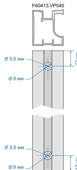
4 Расчет длины рамок: L (рамок) = L (двери) - 78 мм. Нижняя, верхняя и средняя рамки имеют одинаковую длину.
