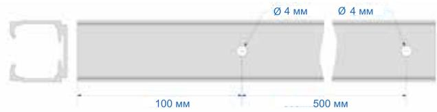
**10** Перед установкой верхней направляющей в проём установите ролик, неподвижную опору, стопор в соответствии с проектом. Произведите монтаж верхней направляющей.
