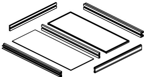
**2** Просверлите вертикальный профиль и установите в края торцевой элемент.
