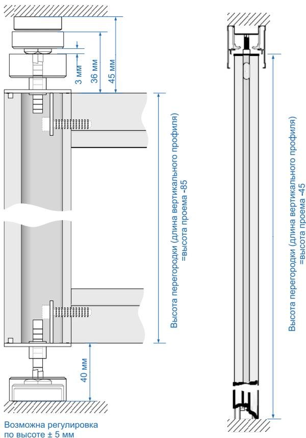
2 Расстояние от края профиля до центра отверстия под сборочный винт равно 17 мм.
