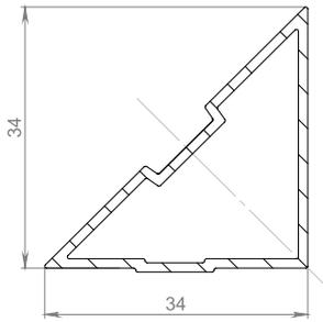
Угловой профиль служит для создания угловых конструкций (под углом 90°, 45°) в шкафах-купе, гардеробных комнатах. Может быть применен при использовании профиля FUSION в раздвижной системе СТАНДАРТ, в 4в1.
