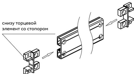
**3** Наденьте все профили на наполнение. Зафиксируйте вертикальный профиль к рамкам саморезами 4x30.
