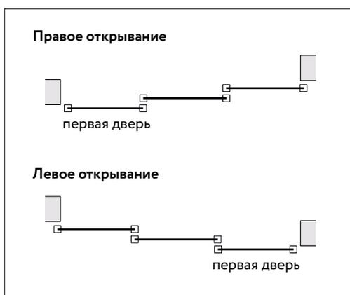
❶ Заведите и зафиксируйте шестигранным ключом стопоры креплений для верхнего ролика в верхних рамках дверей. Для дверей, кроме первой, используйте стопоры из комплекта.
