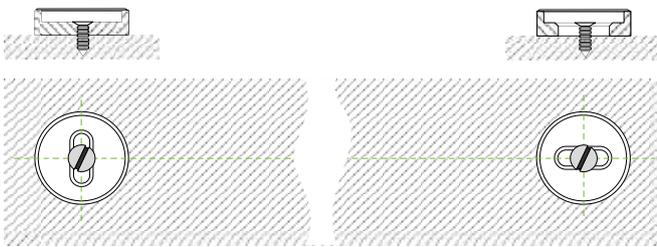
**7** Установите перегородку так, чтобы вкладыши попали в основание регулируемых винтов.
