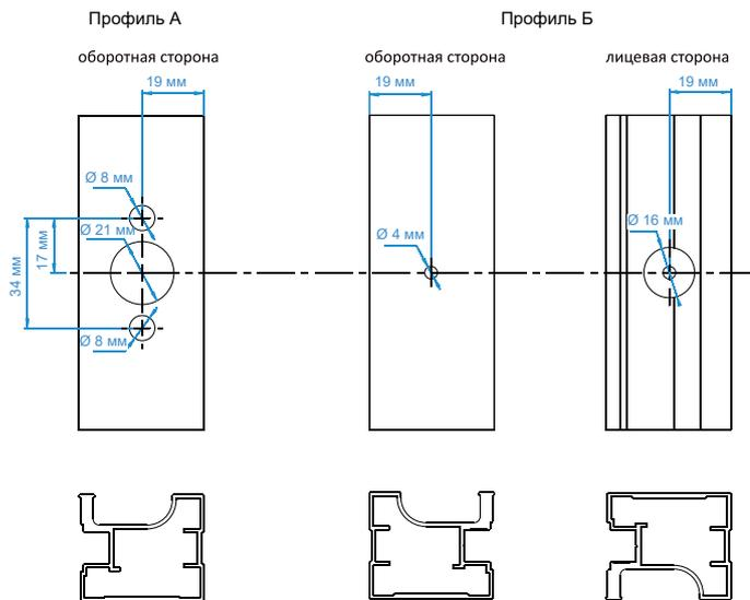
**3** Установите замок в профиль А и зафиксируйте винтами.
