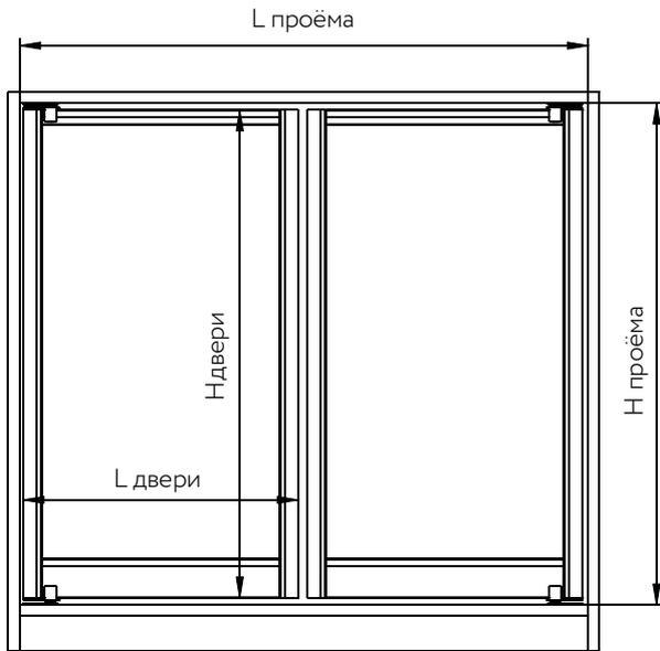
$$L \text{ двери} = (L \text{ прёма} - 20 \text{ мм}) / 2$$
