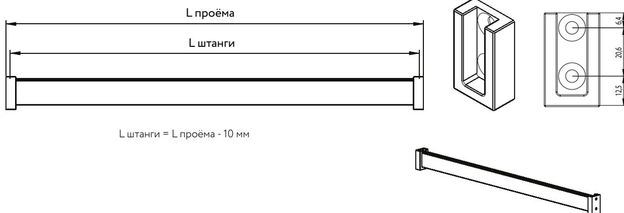
Установка вешала с креплением торцевым и сквозным.
