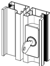
Личинка замка в комплекте выполнена для правого исполнения. Для того, чтобы собрать в левом, необходимо открутить винт (а), повернуть личинку на 180° (б) и винтом зафиксировать ее положение.
