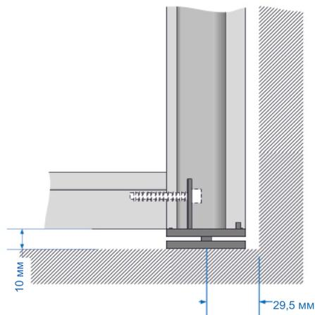
**Стопор складной системы устанавливается для исключения возможности полного сложения створок**
