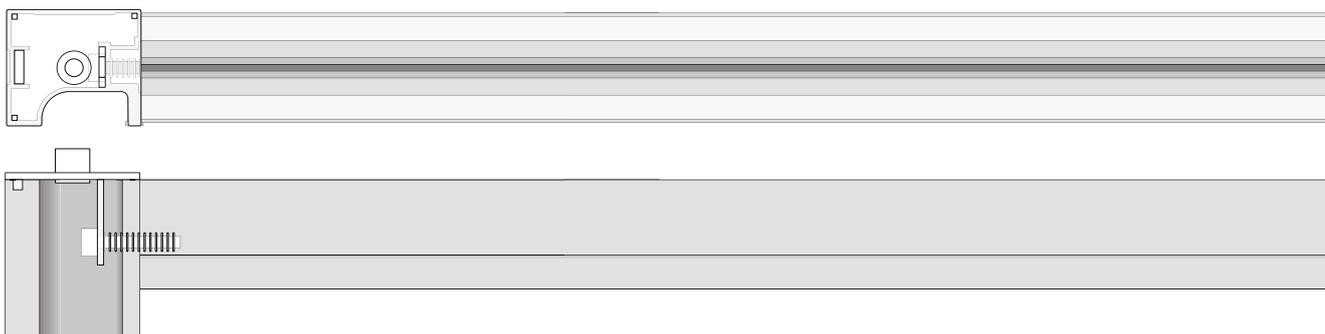
**5** После сборки рамки стационарной перегородки, в основания ножек установите регулируемые винты с надетыми на них декоративными колпачками.
