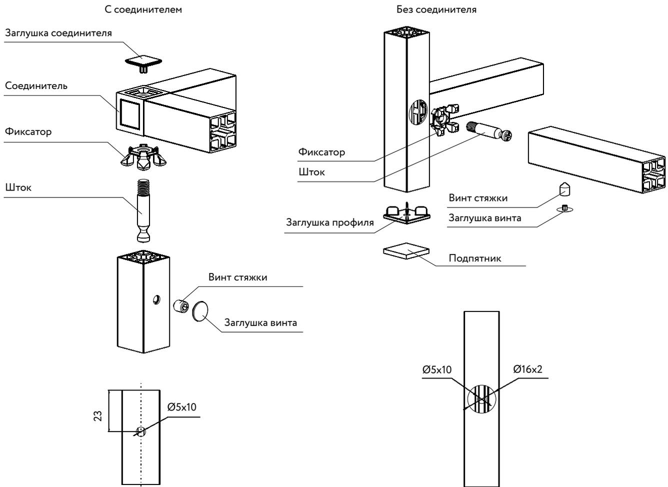
Профиль QB позволяет при необходимости установить полкодержатель или стекло-держатель (5 мм). Для этого в нем сверлится отверстие диаметром 4,8 x 10 мм.
