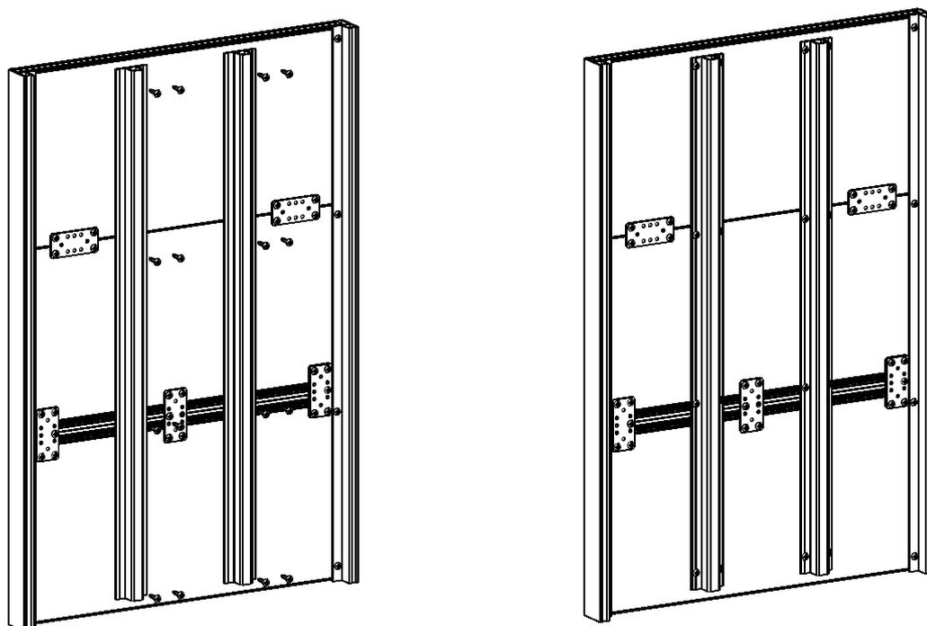
11 Закрепите нижние ролики, доводчики, верхние ролики, кронштейны (при скрытом варианте монтажа) по углам тыльной стороны полотна двери саморезами (3,9x16 мм). Если вставка с зеркалом/стеклом, то используйте саморез 3,9x9,5 мм.
