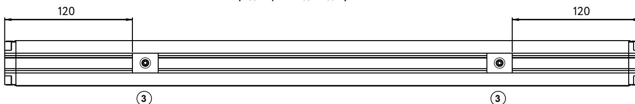
2 Заведите крепления со шкивами в верхнюю рамку дверей, кроме первой, без окончательной фиксации. Сдвиньте основание ролика примерно на 1 мм внутрь крепления.
