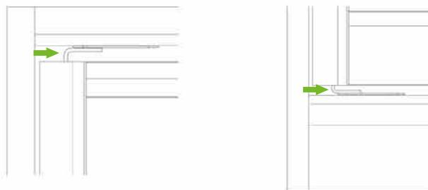
Для регулировки необходимо ослабить сборочный саморез и выдвинуть или задвинуть ось вращения.
