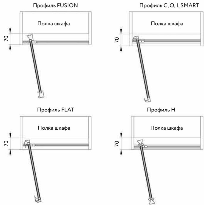
Глубина наполнения = Глубина шкафа - 70 мм
