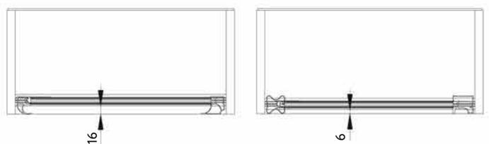
**4** Фиксируем нижнюю закладную шестигранным ключом
