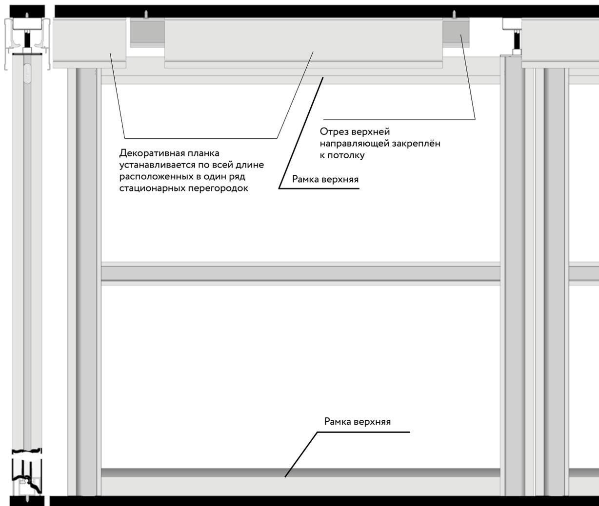
Профиль П (AS0460.VP540) - Длина горизонтальной рамки - 50 мм
