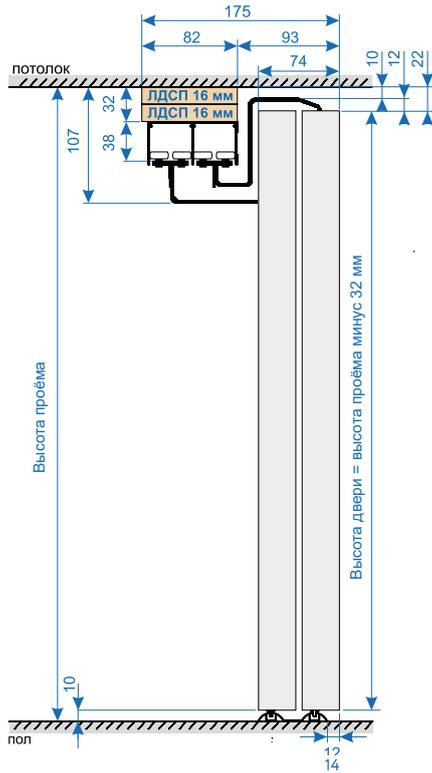
**Скрытая установка направляющей верхней в шкаф**
