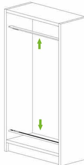
Отступ направляющей в зависимости от конфигурации профиля.
