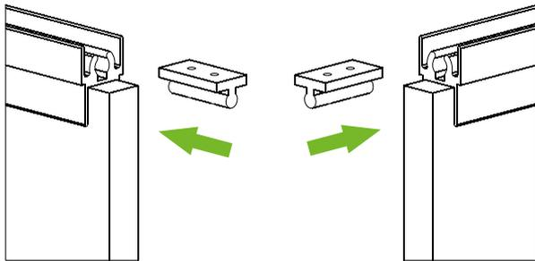
2 Открутите винты и разъедините активатор на две части – захват и основание.
