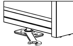
6 После повторной установки двери и окончательной регулировки двери, зафиксируйте гайку снизу.
