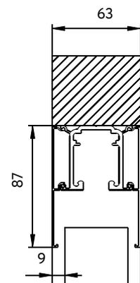
**1** Напилите профиль и наполнение по проекту, используя расчетную таблицу. После этого наденьте соответствующий уплотнитель на наполнение двери толщиной 4 мм или 8 мм.
