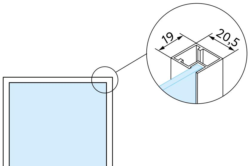
Узкий рамочный профиль 831 для распашных фасадов со стеклянными или зеркальными вставками — прекрасный вариант для создания элегантного и современного дизайна помещения.
