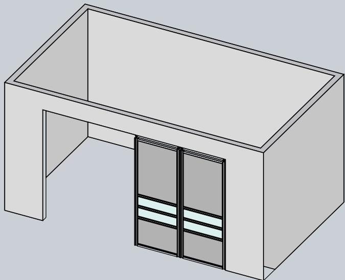
Стационарная перегородка поможет изменить планировку: отгородить или полностью изолировать часть помещения. Она жестко крепится к полу и потолку, несет функцию постоянных стен.
