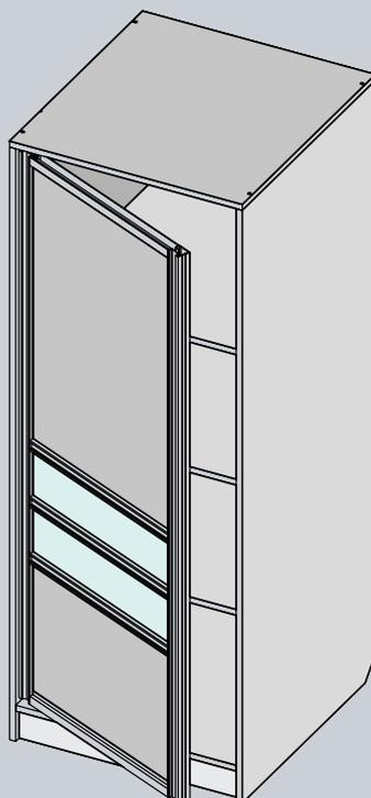
При проектировании двухдверных встроенных шкафов шириной до 1000 мм целесообразно использовать распашные двери. Угол открывания до 150 градусов. При планировке таких дверей необходимо предусмотреть свободное пространство в зоне открывания.
