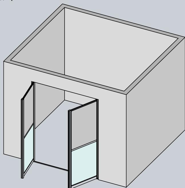
При проектировании двухдверных встроенных шкафов шириной до 1000 мм целесообразно использовать распашные двери. При планировке таких дверей необходимо предусмотреть свободное пространство в зоне открывания.
