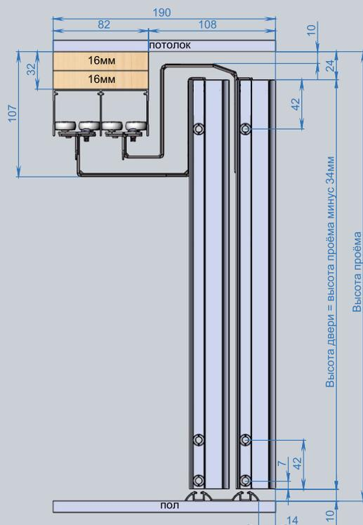
Скрытая установка верхней направляющей в шкаф
