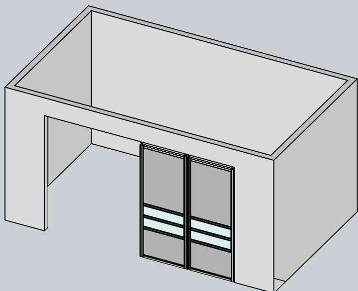
Система подходит для разделения пространства и зонирования помещений, перегородки из стекла выглядят эстетично и современно. Перегородка крепится в распор между полом и потолком, быстро монтируется без повреждения стен и может быть легко перенесена или демонтирована.
