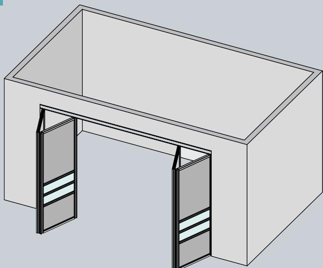
Складные двери позволяют значительно сэкономить пространство. Компактность конструкции идеально подходит для эксплуатации в небольших помещениях, узких коридорах и нишах, где использовать раздвижную систему нецелесообразно. Двери плавно ходят по направляющим, ограничители позволяют зафиксировать дверь в нужном положении.
