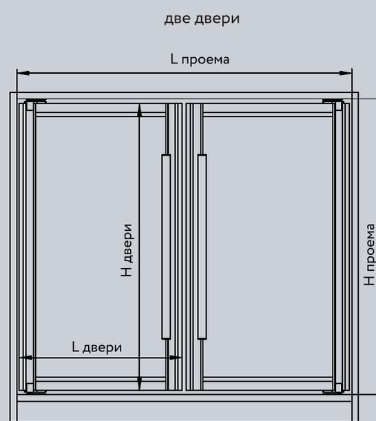
$$L \text{ двери} = L \text{ проема} - 20 \text{ мм}$$
