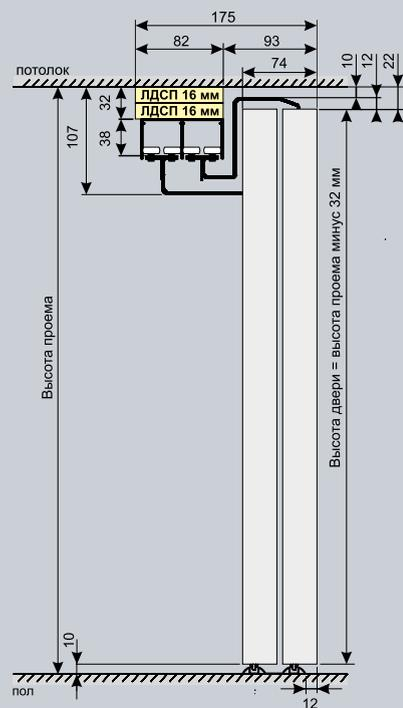
Вариант со скрытой установкой верхней направляющей в шкаф
