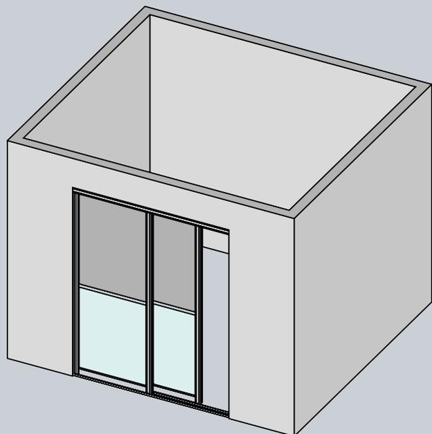
Раздвижные двери идеально подойдут для разделения пространства и создания отдельных функциональных зон. Наличие нижней направляющей позволяет скрыть стык различных покрытий пола и подчеркнуть границы помещений.
