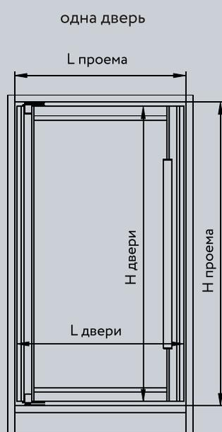
$$L \text{ двери} = L \text{ проема} - 10 \text{ мм}$$
