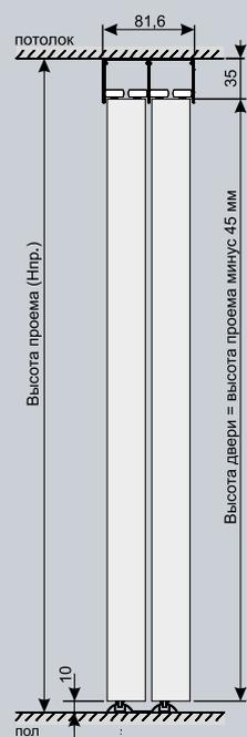
Вариант со скрытой установкой верхней направляющей в проём
