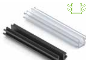
AA0084.VM100 Уплотнитель П-образный, с шипами Цвета: прозрачный, черный Высота – 4 мм, В бухте – 100 м
